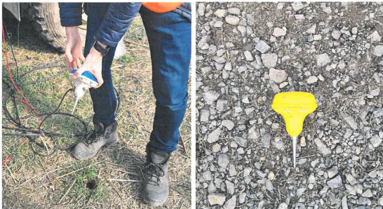
Slika 5. Prikaz geofona (prijamnika)
