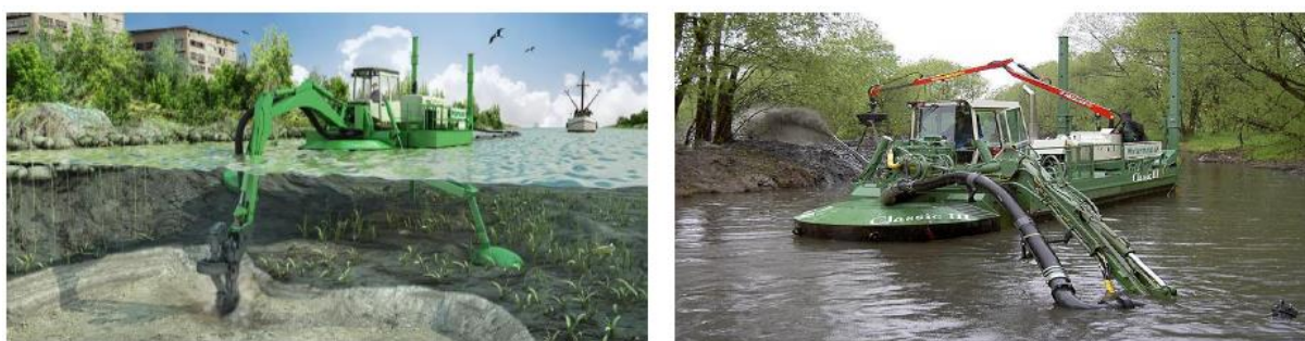
Slika 4. Plovni hidraulični bager - refuler; Izvor: Glavni/izvedbeni projekt RUKAVAC TIŠINA U ČIGOČU, FAZA: IZMULJIVANJE RUKAVCA na k.č. 194/15, k.o. Čigoč, Grad Sisak, Sisačko-moslavačka županija, Oznaka projekta: E-111-21 01, Izrađivač: Geokon-Zagreb d.d., Zagreb, lipanj 2022.
