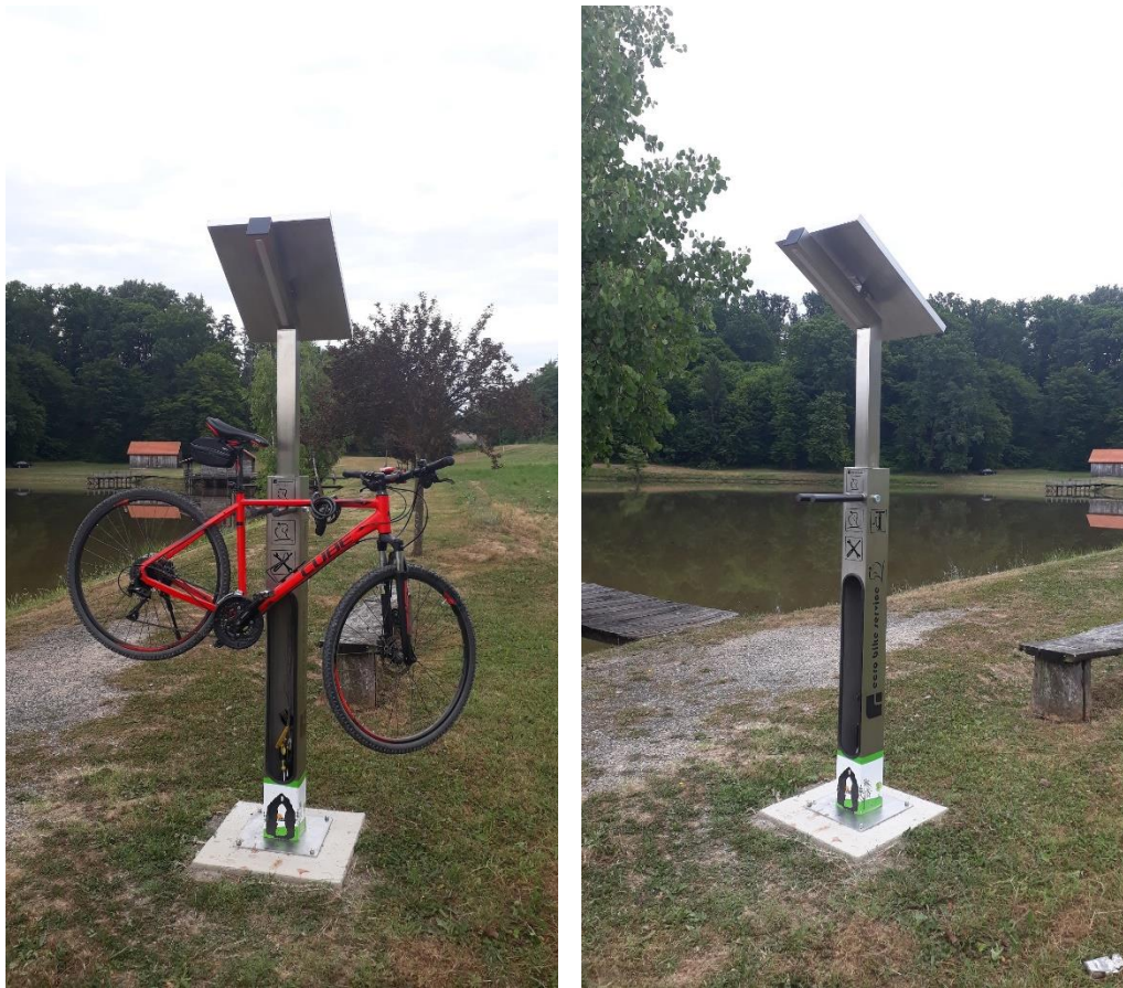
Slika 33: Solarni stup za brzi popravak bicikala
